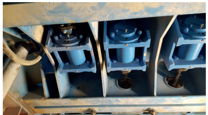
Umbau auf Axis-Vibrosystem ohne Austausch des Tisches in Tüßling, Deutschland
