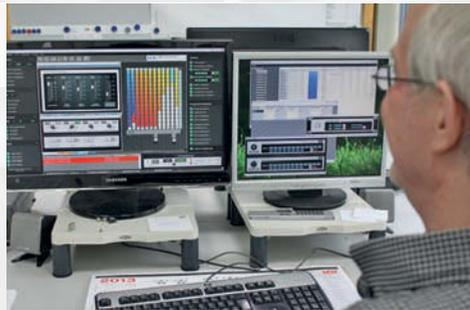
Zur Verbesserung des Services hat **FRIMA** ein Fernwartungskonzept entwickelt. Mit diesem können wir ohne zusätzliche Installation von Hardware via VPN Tunnel über einen Standard-PC auf die Anlagensteuerung und alle vernetzten Anlagenteile zugreifen.
