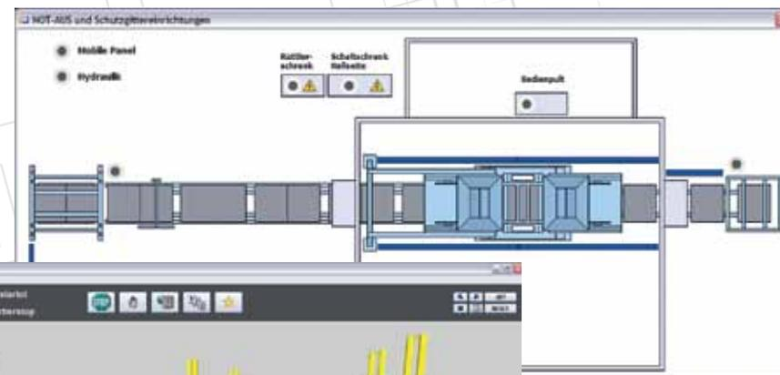
Система визуализации быстро связывается с помощью Profinet(Ethernet) с системой управления. Машины изображены графически в 3D-формате и могут свободно вращаться и уменьшаться или увеличиваться на экране. Интерактивное изображение на экране отражает точные движения всех частей линии.
