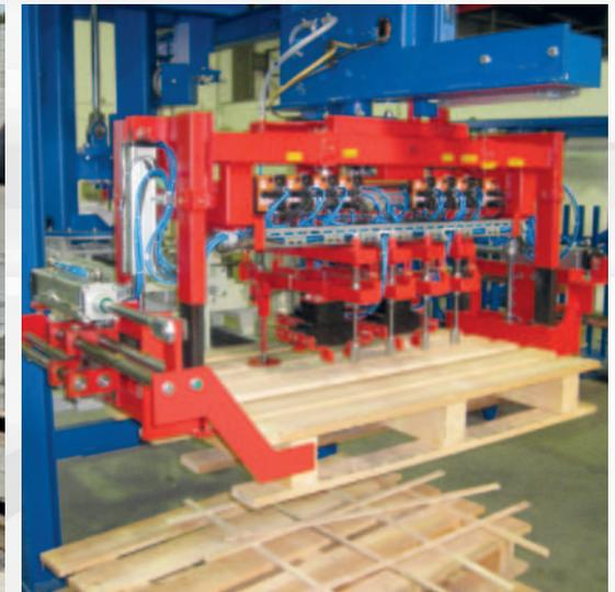
Im Bereich des Steinpaketaustrages müssen oft Transportpaletten zugeführt werden oder zwischen die Steinlagen zum Schutz Leisten eingelegt werden.
