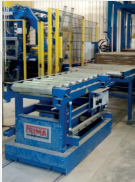
Systeme zur Rückführung der Leerbretter von der Trocken- zur Nasseite mit Brett-puffersystemen. Nass- bzw. Trockenseite können damit unabhängig voneinander produzieren.
